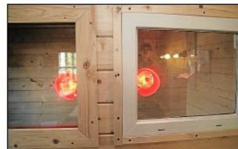
Wärmevergleich: Links ein dreifach-, rechts ein einfach verglastes Fenster.
